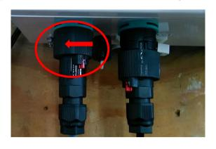
・接続カバーを外したらコネクタを抜きます。
