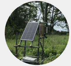
太陽光電源装置
