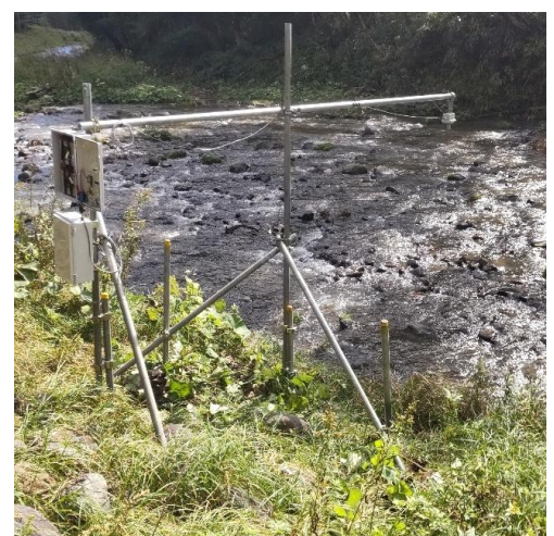
河川工事での活用例 上流の雨量予測 現場の雨量予測 水位の観測値を一元管理し安全対策に役立てます。
