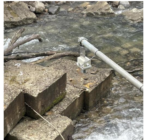
電池式水位計で河川の水位を観測。電源不要で稼働することができます。
