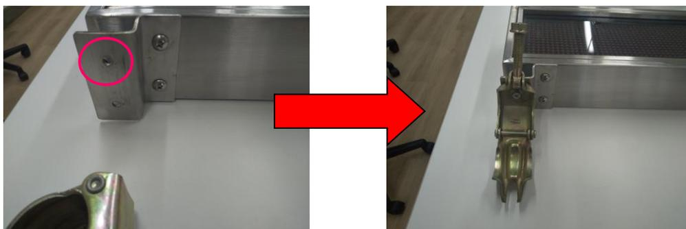
上図のように電光掲示板左右下部の赤丸部に単クランプを取り付けます。
