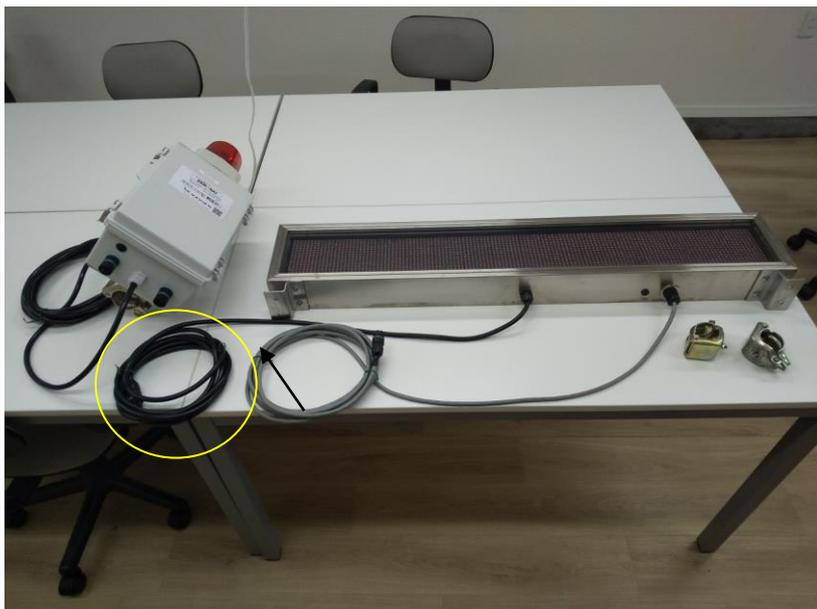
上図のように電光掲示板側の電源ケーブル（3芯、黒色）をパトライト底部の差し込み口に取り付けます。
